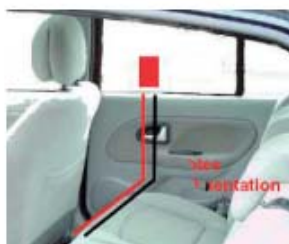
Kablerne trækkes så transponderen nemt kan tilsluttes strøm.
