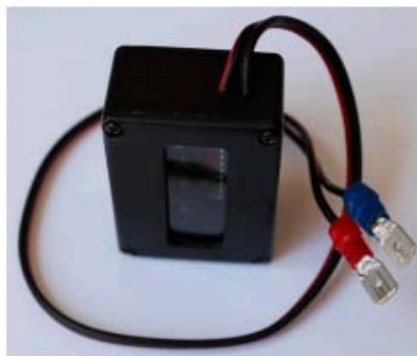
Transponderen måler 37x 53 x 22 mm. (B x H x D)
