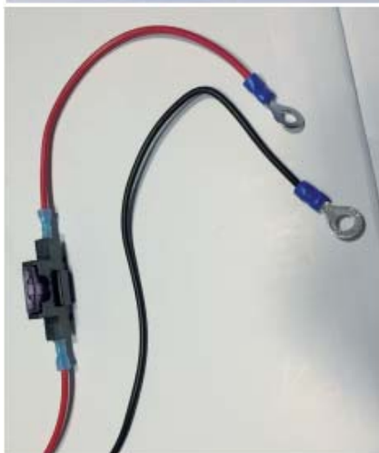
Kablerne skal monteres direkte på batteriet og +ledningen forsynes med en sikring på 3-5 amp.
